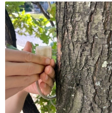
Installation von Saftflusssensoren (links), Aufzeichnung der Bodenfeuchte in verschiedenen Tiefen und des Saftflusses an unterschiedlichen Bäumen (rechts), Malkin Gerchow, JKI
