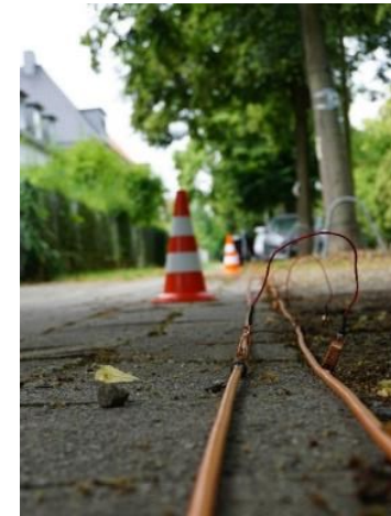
Geoelektrische Messung (links) und Veränderung des spezifischen elektrischen Widerstandes im Boden (oben), Johannes Hoppenbrock, JKI
