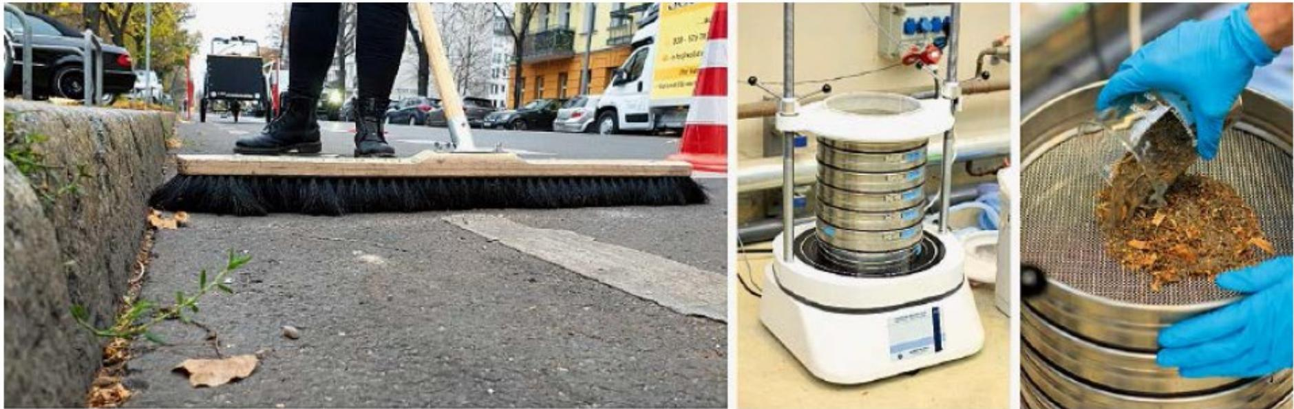
Abb. 10: Kehrlichtbeprobung an der Hochstraße in Berlin-Wedding (links), Aufbringung und Siebung der Kehrproben ( $0\ \mu\text{m}$  bis  $> 1000\ \mu\text{m}$ ) (mittig und rechts, Fotos: Daniel Geisler)
